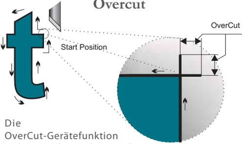
Die OverCut-Gerätefunktion verlängert das Ende von den Schnittlinien. So wird speziell in den Ecken sichergestellt, daß Grafiken immer vollständig geschnitten werden. Ohne "OverCut" könnten vielfältige Unterschiede in Material und Software dazu führen, daß Linien nicht komplett geschnitten werden, was dann immer zu Problemen beim Entgittern führt.
