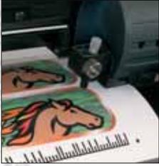
OPOS ist das zuverlässige **optische System** zum automatischen Konturenschneiden für das Produzieren von Aufklebern. Es erhöht die Produktivität der Arbeitsläufe beim wiederholenden Schneiden von Konturen. Die OPOS X Technik erkennt Markierungen auf einer großen Vielzahl von Medien. Dadurch daß OPOS Barcodes automatisch lesen kann, entsteht ein vollautomatischer Arbeitsprozeß der unmittelbar aufeinander folgendes Schneiden von vielen Konturenschnitten ermöglicht. Einer nach dem Anderen!
